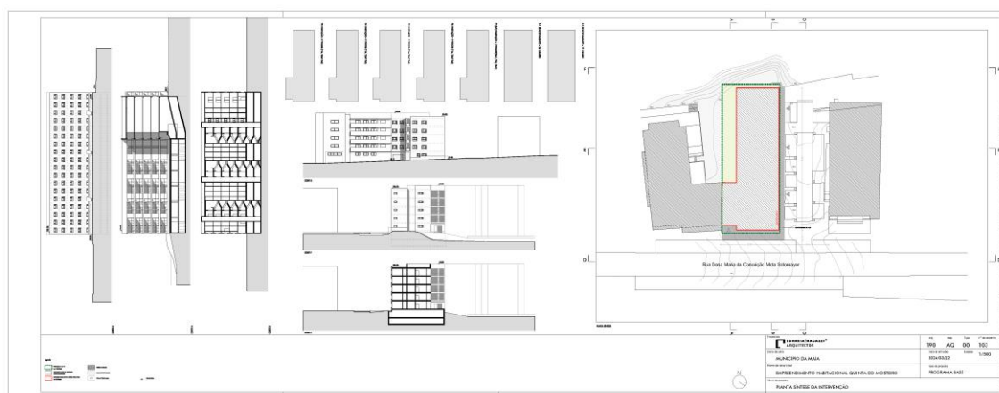
Planta de implantação, alçados e cortes do projeto do novo edifício
